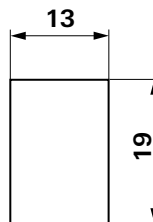
Einbauöffnung für den Umschalter ohne Blende
